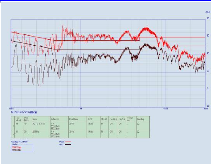
输入N线 (未加滤波器) 测试CE波形
