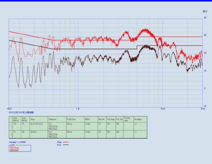
输入L线 (未加滤波器) 测试CE波形
